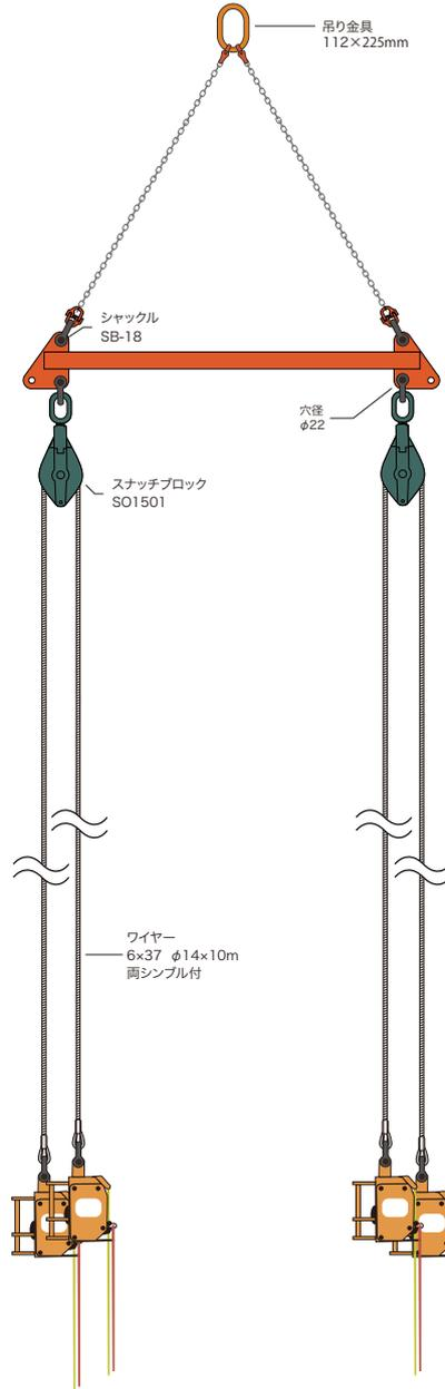
横向きで地組みした柱を立起こす際、ワイヤー4点均等荷重で安全に吊り上げることができます。
